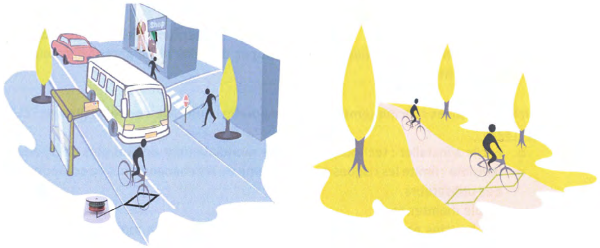
Figure 1 : schéma d'implantation de boucles électromagnétiques en situation de trafic mixte ou sur voie dédiée
