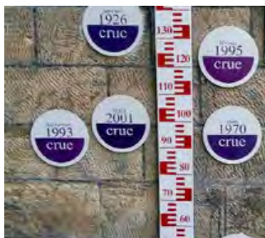
Repères de crue
