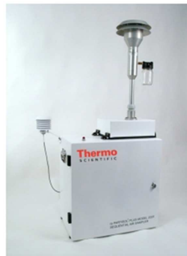
Figure 245 : PARTISOL PLUS 2025 BAP (source : EcoMesure)
