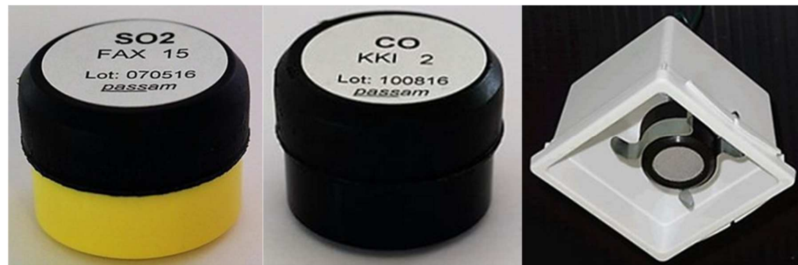
Figure 244 : Capteurs de dioxyde de soufre et de monoxyde de carbone et disposition dans le boîtier (source : Passam)
