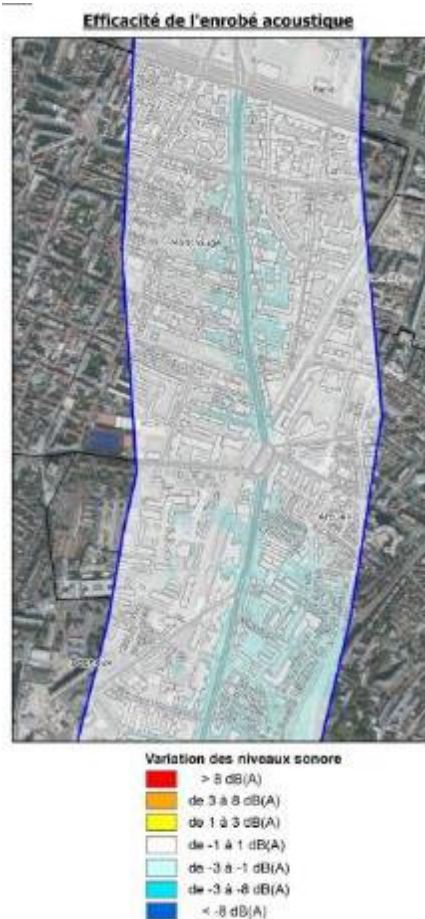
Figure 19 : Efficacité des enrobés acoustiques en 2050 sur la partie Nord de l'aménagement
