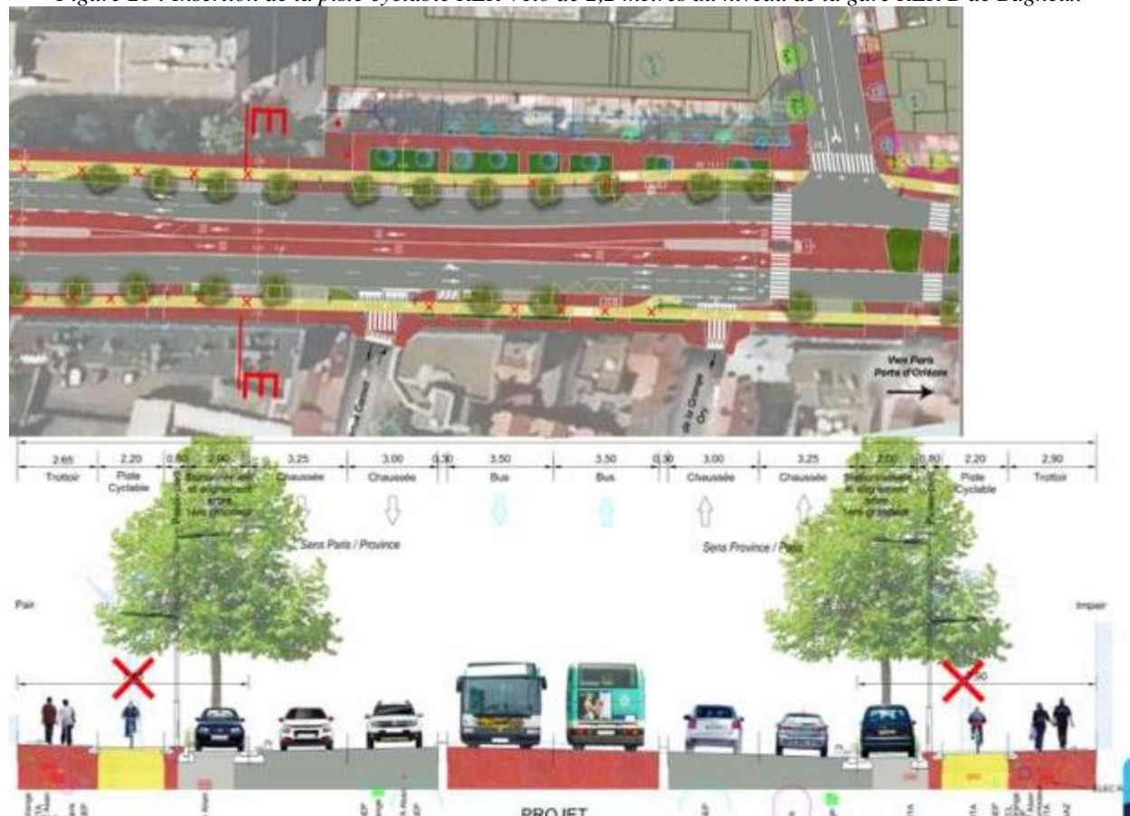
Figure 21 : Insertion de la piste cyclable RER Vélo de 2,2 mètres entre l'avenue Carnot et la rue de Verdun
