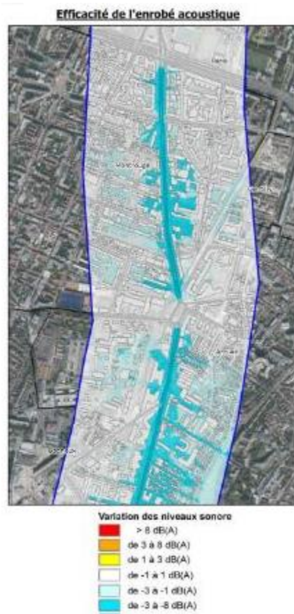
Figure 18 : Efficacité des enrobés acoustiques en 2030 sur la partie Nord de l'aménagement
